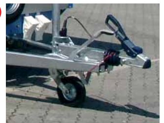
Sicherheits-Anhängekupplung (auf die Kupplungskugel wirkende Beläge unterdrücken Pendelbewegungen während der Fahrt). Für Anhänger bis 3000 kg Gesamtgewicht (gegen Mehrpreis).
