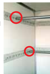
Zubehör Zurrschiene Barthau TOPZURR24. Genauso wie im Rahmenprofil können in der Barthau Zurrschiene die Nockenfitting auf die ganze Länge und vorne montiert werden. Zusätzlich können auch Absperrstangen rund verzinkt auf die ganze Länge und auf 2 Höhen eingesetzt werden. Diese optimale Ladungssicherung ist für jede Ladung nutzbar und unentbehrlich.
