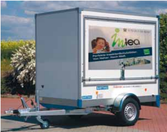
CT 1801 mit Sonderwunsch: Verkaufsklappe links mit großen stabilen Gasfedern und Feststeller, Brüstung 500mm hoch. Serienmäßig von innen verriegelt oder gegen Mehrpreis mit Drehstangenverschluss von außen abschliessbar.
