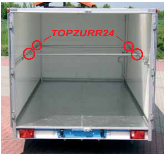
Zubehör: Boden mit 1,5 mm Alublech belegt. Zusätzlich wurden beidseitig seitlich 1 m über den Anhängerboden noch Zurrschienen für TOPZURR24 montiert. In dieser Zurrschiene können Nockenfitting oder Absperrstangen eingehängt werden.
