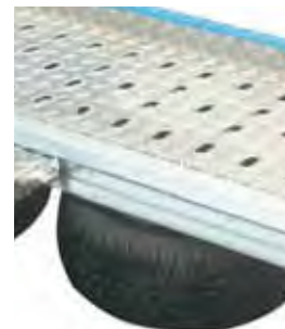
Zubehör: Ersatzrad mit Halterung rechts unter der Ladeschiene montiert.
