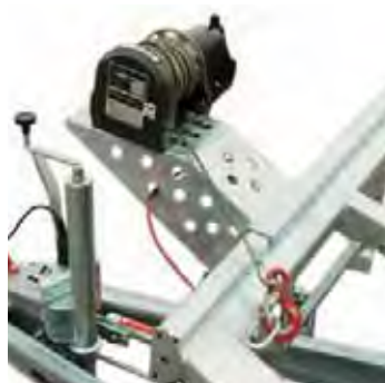
Elektrische Seilwinde als Zubehör mit Haken und Fernbedienungskabel (1000 oder 1500 kg Zugkraft) an stufenlos verstellbarem Windenbock. Anschluß 12 oder 24 Volt möglich.
