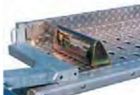
Verstellkeile zur Ladungssicherung, über die gesamte Anhängerlänge verstellbar. Gurtösen, am Rahmen angeschweißt.
