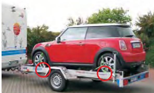
QM 1801 mit Zubehör Kotflügel aus Alu-Riffelblech, Rohrstützen mit Klemmhalterung und Stoßdämpfer für 100 km/h-Zulassung.
