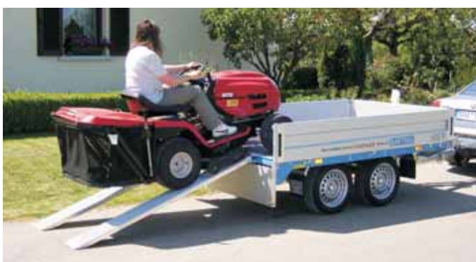
EH 1602 befahrbar durch Zubehör Aluminium-Rampen 2000 mm lang, 220 mm breit, Tragkraft lt. Prospekt 0.2. Die Rampen haben eine griffige Lauffläche und sind durch die Bolzenarretierung gegen Abrutschen gesichert. Zum Transport können die Rampen in Halterungen unter der Ladefläche eingeschoben oder lose auf den Anhänger gelegt werden. Bei Länge 2010 mm und Breite 1260 mm können die Rampen nur lose auf dem Anhänger transportiert werden, da für diese Größen keine Halterungen unter dem Anhänger montiert werden können. (Bei Auffahrampen mit Halterungen kann keine Ersatzradhalterung unter dem Boden montiert werden.)
