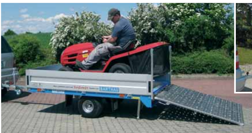
EH 2002 serienmäßig mit hohem Rahmen und 14-Zoll-Bereifung. Aluminium-Bordwände 350 mm hoch, 4seitig abklappbar und werkzeuglos abnehmbar. Zubehör: Aluminium-Aufsatz 350 mm hoch. Bitte beachten: Auf Aufsätze können keine Dachgestelle montiert werden.
