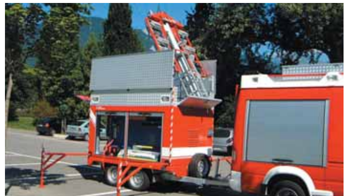
EH 2002 in RAL3000 gepulvert und mit Feuerwehraufbau als Beleuchtungsanhänger mit elektrisch ausfahrbarem Mast und stabilen Stützen.
