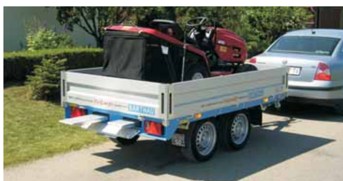
EH 1602 befahrbar durch Zubehör Aluminium-Rampen 2000 mm lang, 220 mm breit, Tragkraft lt. Prospekt 0.2. Die Rampen haben eine griffige Lauffläche und sind durch die Bolzenarretierung gegen Abrutschen gesichert. Zum Transport können die Rampen in Halterungen unter der Ladefläche eingeschoben oder lose auf den Anhänger gelegt werden. Bei Länge 2010 mm und Breite 1260 mm können die Rampen nur lose auf dem Anhänger transportiert werden, da für diese Größen keine Halterungen unter dem Anhänger montiert werden können. (Bei Auffahrampen mit Halterungen kann keine Ersatzradhalterung unter dem Boden montiert werden.)
