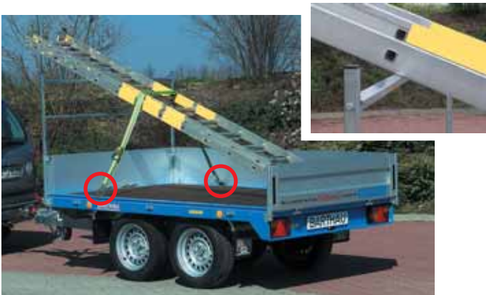
EH 2002 serienmäßig mit hohem Rahmen und 14-Zoll-Bereifung. Aluminium-Bordwände 350 mm hoch, 4seitig abklappbar und werkzeuolos abnehmbar. 4 Stück Eckrungen gesteckt, versenkte Verschlüsse. Zubehör H-Galerie vorne, oberes Rohr drehbar, paßt sich der Ladung an, z. B. kein Knick in der Alu-Leiter.
