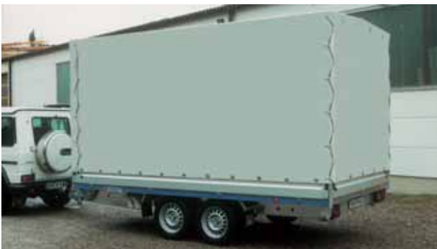
SP Zubehör PVC-Plane und Dachgestell aus verzinktem Vierkanrohr geschraubt mit 100mm Steigung. Besonders zu empfehlen ist, wenn das Dachgestell und die Plane als Schiebeplane ausgerüstet werden. Die Schiebeplane mit Leichtlaufrollen aus Metall läßt sich spielend leicht nach vorne ziehen, der Anhänger ist schneller offen. Bei normaler Plane lässt sich eine große Plane nur schwer nach oben werfen und der Wind weht sie leicht wieder herunter. Jede Höhe für Anhänger lieferbar, jedoch nicht mit einschiebbarer Plane (Kasackplane) und nicht mit Zollverschluß.
