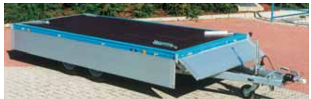
SP-Aluminium-Bordwände 400mm hoch, rundum abklappbar und abnehmbar, 4 steckbare Eckrungen und ein Plattformanhänger ist fertig.
