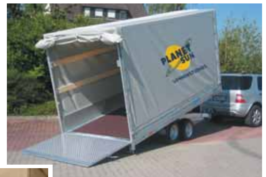
SP Zubehör PVC-Plane und Dachgestell aus verzinktem Vierkanrohr geschraubt mit 100mm Steigung. Besonders zu empfehlen ist, wenn das Dachgestell und die Plane als Schiebeplane ausgerüstet werden. Die Schiebeplane mit Leichtlaufrollen aus Metall läßt sich spielend leicht nach vorne ziehen, der Anhänger ist schneller offen. Bei normaler Plane lässt sich eine große Plane nur schwer nach oben werfen und der Wind weht sie leicht wieder herunter. Jede Höhe für Anhänger lieferbar, jedoch nicht mit einschiebbarer Plane (Kasackplane) und nicht mit Zollverschluß.
