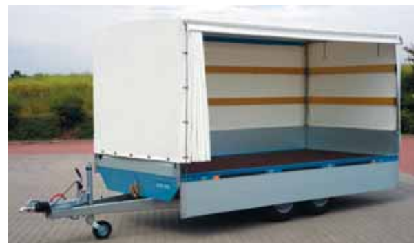
SP Zubehör PVC-Plane und Dachgestell aus verzinktem Vierkanrohr geschraubt mit 100mm Steigung. Besonders zu empfehlen ist, wenn das Dachgestell und die Plane als Schiebeplane ausgerüstet werden. Die Schiebeplane mit Leichtlaufrollen aus Metall läßt sich spielend leicht nach vorne ziehen, der Anhänger ist schneller offen. Bei normaler Plane lässt sich eine große Plane nur schwer nach oben werfen und der Wind weht sie leicht wieder herunter. Jede Höhe für Anhänger lieferbar, jedoch nicht mit einschiebbarer Plane (Kasackplane) und nicht mit Zollverschluß.
